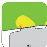
Lo speciale profilo brevettato sulla superficie dell'anello esterno dell'unità KART SKF è stato progettato per ridurre il rischio di disallineamento rispetto al supporto durante la corsa
